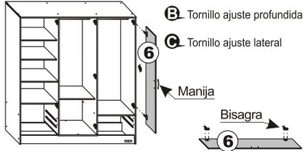
Hacer coincidir las bisagras de las PUERTAS en los tornillos de las bases y deslizarlas hasta que ambas ranuras calcen en sus respectivos lugares.
