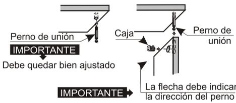
Colocar los 4 FRENTE 0 en posición horizontal con las perforaciones hacia arriba y en las dos perforaciones centrales, enroscar los pernos del minifix.
