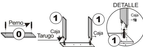
Se recomienda colocar adhesivo en las perforaciones por donde van los tarugos. Unir los LATERALES 1 al FRENTE, haciendo coincidir perforaciones con pernos y tarugos (tener en cuenta que el canal por donde se desliza el FONDO debe ir hacia adentro). Girar las "cajas" hasta que quede bien fija la unión.
