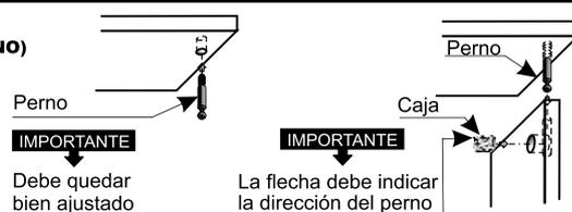
y ensamblar al mueble haciendo coincidir las perforaciones con los pernos colocados, luego girar las "cajas" hasta lograr la firmeza necesaria.
