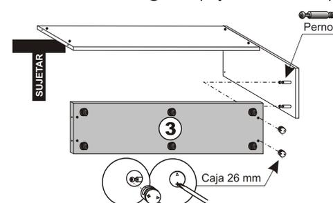
**4-** Colocar los pernos en el COSTADO ①, las cajas de 26 mm en el PISO ③ y las cajas de 15 mm en la TRAVIESA ②. Unir el COSTADO ① a la TRAVIESA y PISO.
