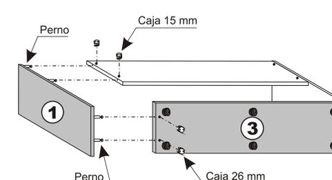
**2-** Colocar los pernos en las perforaciones del COSTADO ①. Colocar las cajas de 15 mm en la TRAVIESA ② y unir mediante el sistema de unión minifix (ver recuadro).
