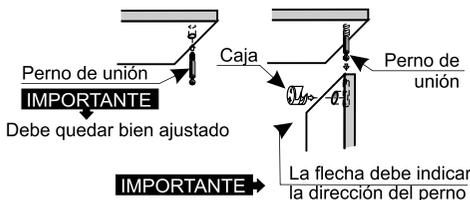
Colocar los 3 FRENTE 0 en posición horizontal con las perforaciones hacia arriba y en las dos perforaciones centrales, enrosacar los pernos del minifix.
