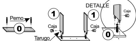
Se recomienda colocar adhesivo en las perforaciones por donde van los tarugos. Unir los LATERALES 1 al FRENTE, haciendo coincidir perforaciones con pernos y tarugos (tener en cuenta que el canal por donde se desliza el FONDO debe ir hacia adentro). Girar las "cajas" hasta que quede bien fija la unión.
